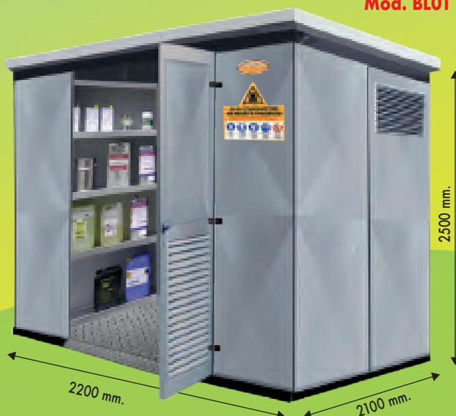
**BOX ARIEGGIATO** per vari usi, costruito in pannelli modulari in **LAMIERA ZINCATA DX51D+Z, PRESSOPIEGATA**, assemblati tramite bulloneria ad innesto, senza saldature. Fori per arieggiamento. Realizzato su misura.
